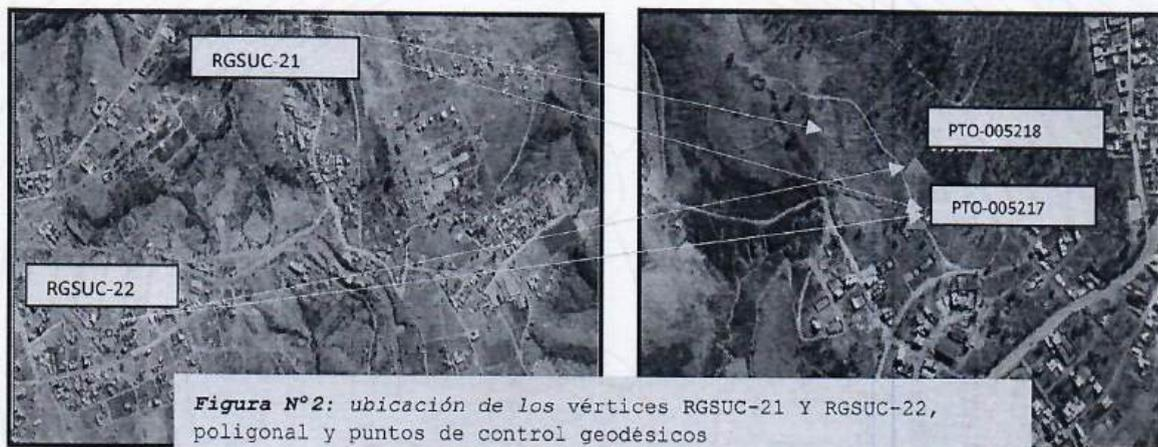
**Figura N°2:** ubicación de los vértices RGSUC-21 Y RGSUC-22, poligonal y puntos de control geodésicos
