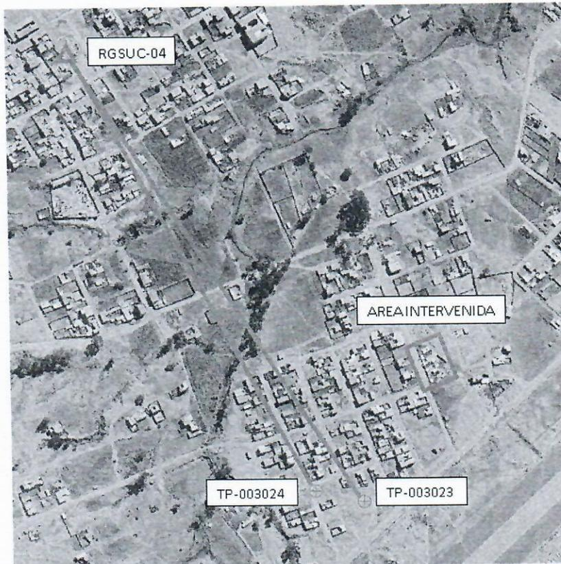
**Figura N°2:** Ubicación vértice RGSUC-04 y puntos de control geodésicos PT003023 Y PT003024.
